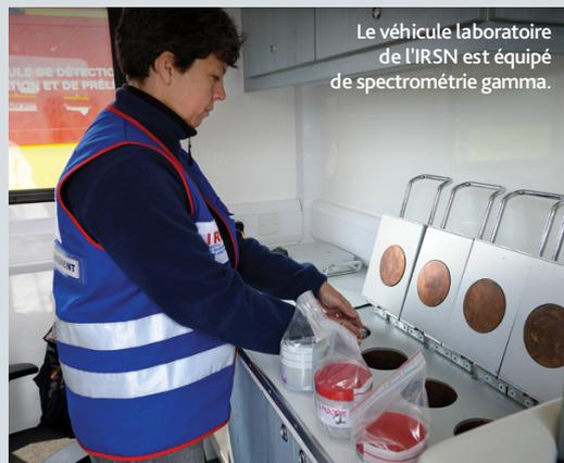
Le véhicule laboratoire de l'IRSN est équipé de spectrométrie gamma.
