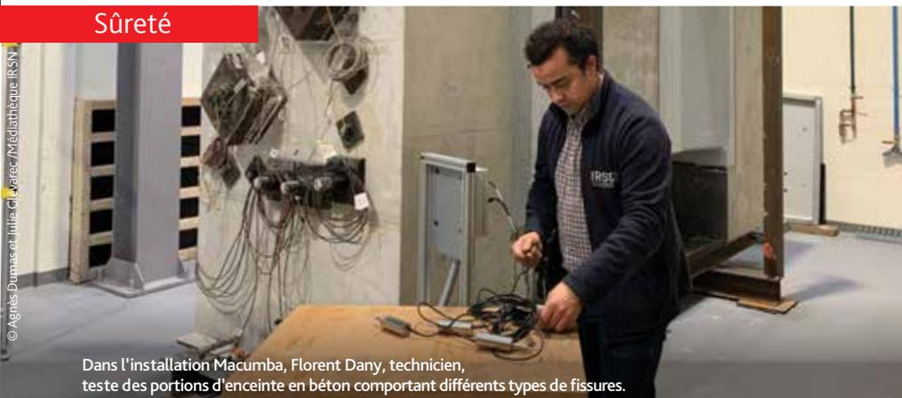
Dans l'installation Macumba, Florent Dany, technicien, teste des portions d'enceinte en béton comportant différents types de fissures.
