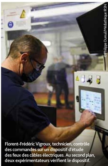
Florent-Frédéric Vigroux, technicien, contrôle des commandes sur un dispositif d'étude des feux des câbles électriques. Au second plan, deux expérimentateurs vérifient le dispositif.
