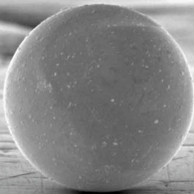
La bille de tungstène a un diamètre de 15  $\mu\text{m}$ .
