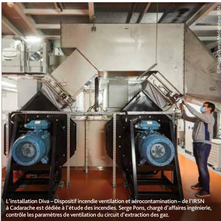
L'installation Diva – Dispositif incendie ventilation et aérocontamination – de l'IRSN à Cadarache est dédiée à l'étude des incendies. Serge Pons, chargé d'affaires ingénierie, contrôle les paramètres de ventilation du circuit d'extraction des gaz.
