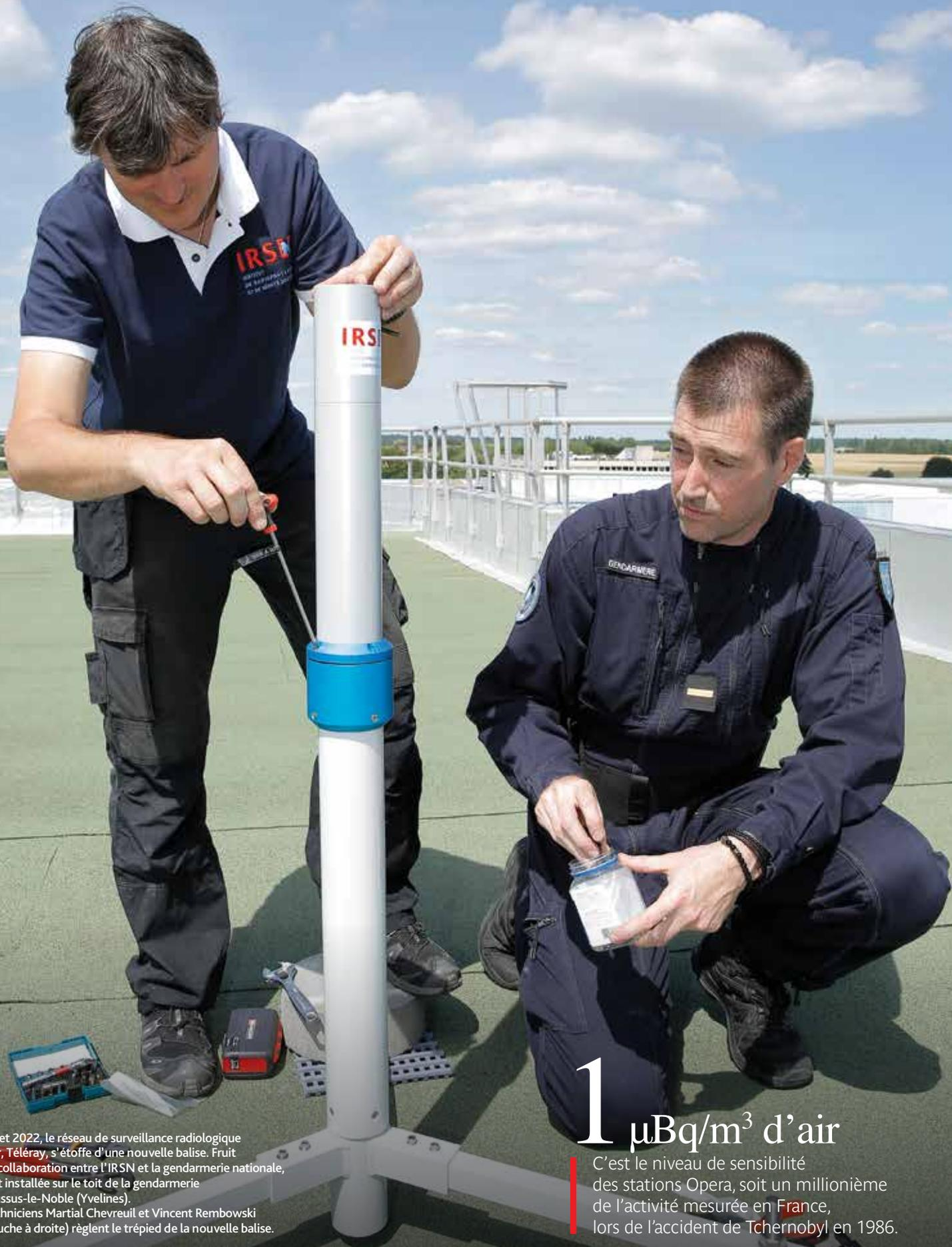
En juillet 2022, le réseau de surveillance radiologique de l'air, **Téléray**, s'étoffe d'une nouvelle balise. Fruit d'une collaboration entre l'IRSN et la gendarmerie nationale, elle est installée sur le toit de la gendarmerie de Toussus-le-Noble (Yvelines). Les techniciens Martial Chevreuil et Vincent Rembowski (de gauche à droite) règlent le trépied de la nouvelle balise.
