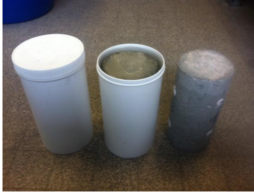
Figure II.9 : conservation des éprouvettes dans l'eau
