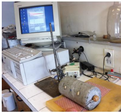
Figure II.13 : dispositif de mesure du module dynamique
