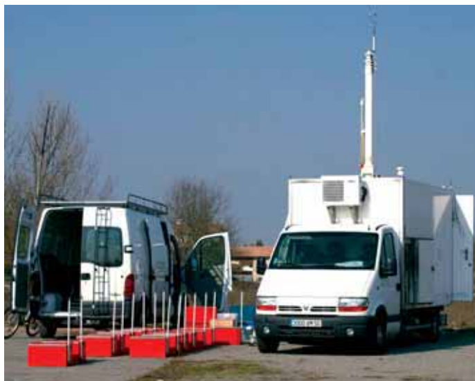
Station micro-météorologique et dispositifs de prélèvements du gaz SF 6 utilisés dans le cadre du projet CAPITOUL par le laboratoire d'Octeville.
