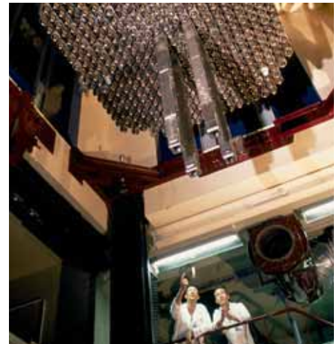
Vue de dessous du réacteur MASURCA, pendant la descente des barres de combustible.
