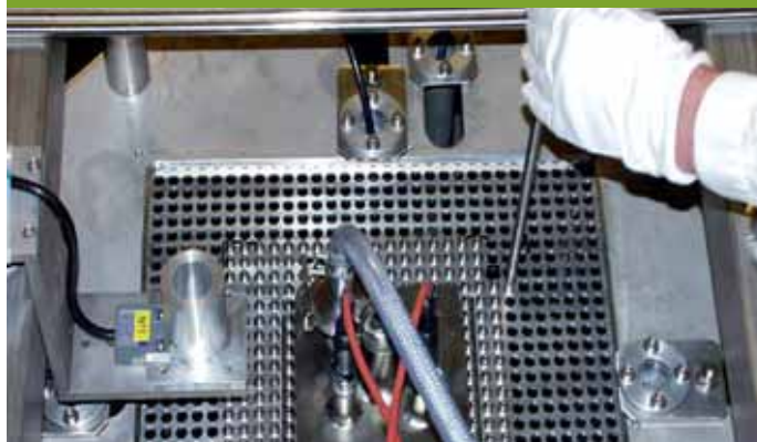
Dispositif expérimental à Valduc destiné à la réalisation d'expériences de criticité.
