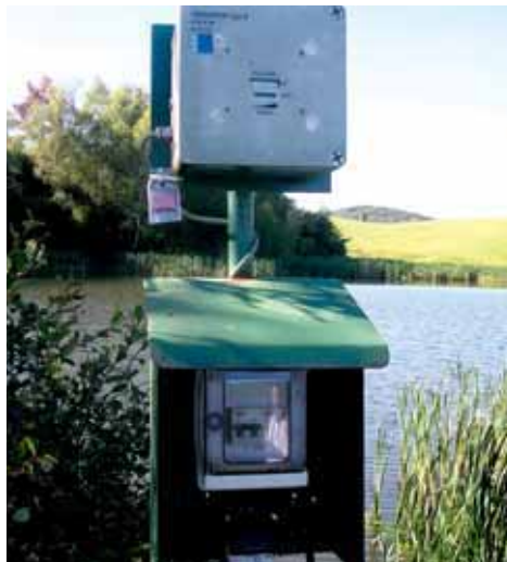
Dosimètre de site Cogema pour la surveillance de l'ancien site minier de Saint-Pierre du Cantal.
