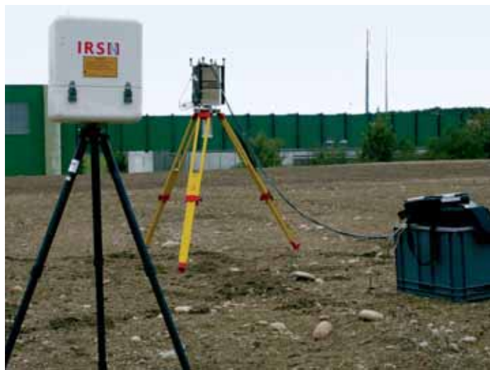
Instrumentation gamma in situ aux abords du CERN pour la réalisation du point zéro radioécologique (Genève).
