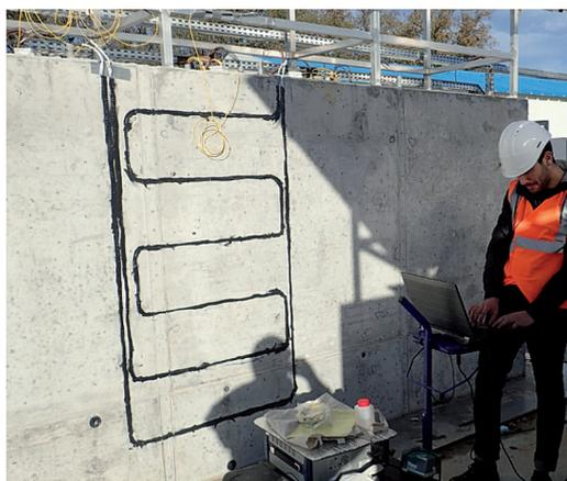
En parallèle, des blocs de béton du projet ODOBA ont été instrumentés au moyen de câbles fo noyés et collés en parement (les blocs ZA et IB). L'objectif est de démontrer l'aptitude de cette instrumentation pour la détection et le suivi à long terme des pathologies potentiellement rencontrées sur les enceintes des centrales nucléaires (réaction sulfatique interne : RSI, réaction alcali-granulat : RAG et couplage RAG/RSI).
