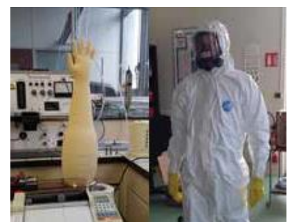
Banc d'essais EPI. Essais avec gant et tenue étanche non ventilée (TENV). Photos : LECEV. Gauche : essais avec tenue étanche ventilée (TEV). Photo : O. Seignette, M. Lafontan/Médiathèque IRSN.
