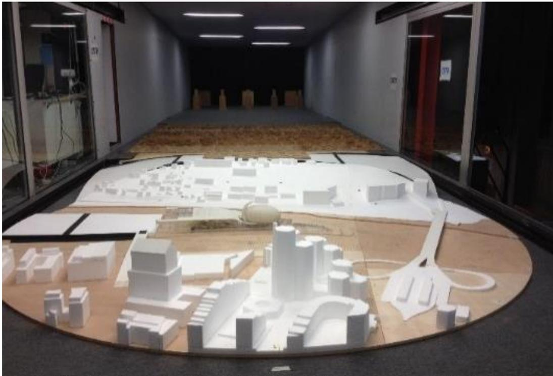
**Figure 32 : Exemple d'essai en soufflerie NSA au CSTB**
