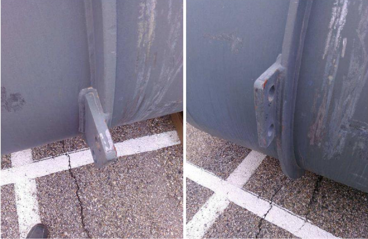
Figure 1: Oreille soudée sur un cylindre 48Y
