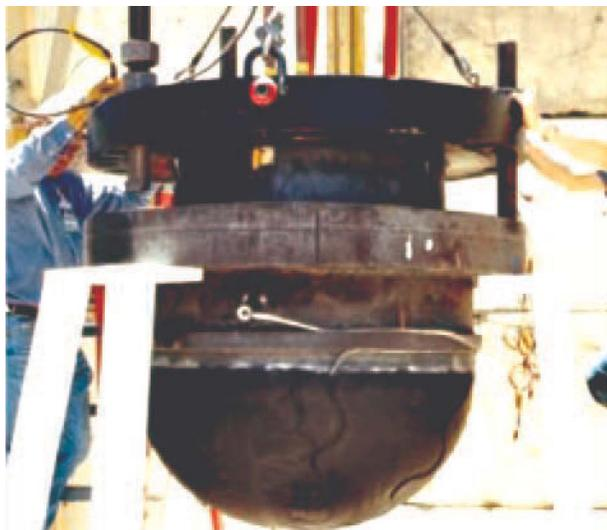
**Figure 5.6.** Maquette du fond de la cuve pour les essais OLHF à l'échelle 1/5<sup>e</sup> et mise en place de son système de chauffage interne par induction.
