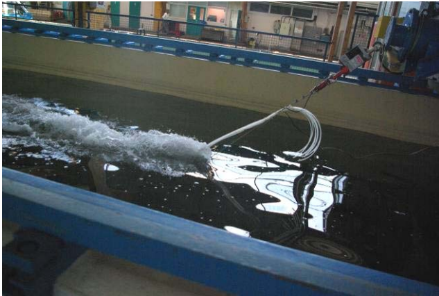
Figure 7 Traction de dix tuyaux sans carénage, canal d'essais de Brest
