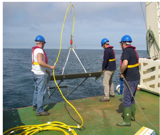
Figure 29 Sondeur fixé sous l'aile
