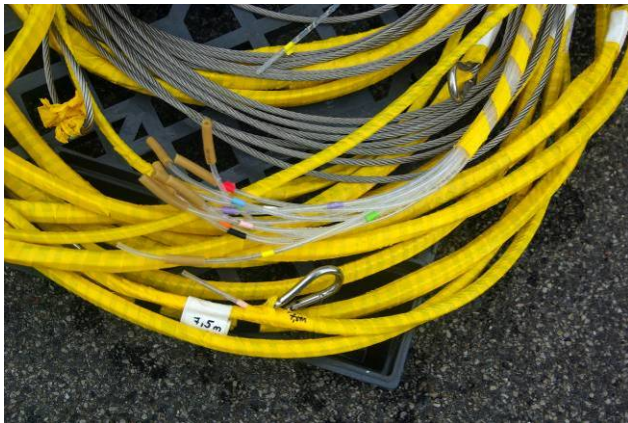
Figure 9 Ligne de prélèvement avec mousqueton de fixation et raccords-pompes
