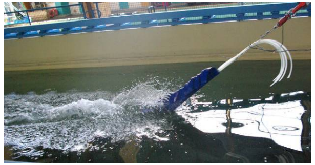
Figure 8 Traction de dix tuyaux avec carénage, canal d'essais de Brest
