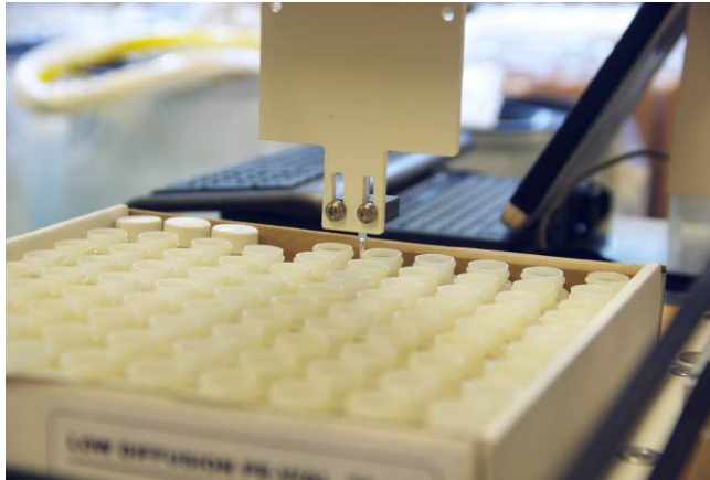
Figure 38 Remplissage du liquide scintillant
