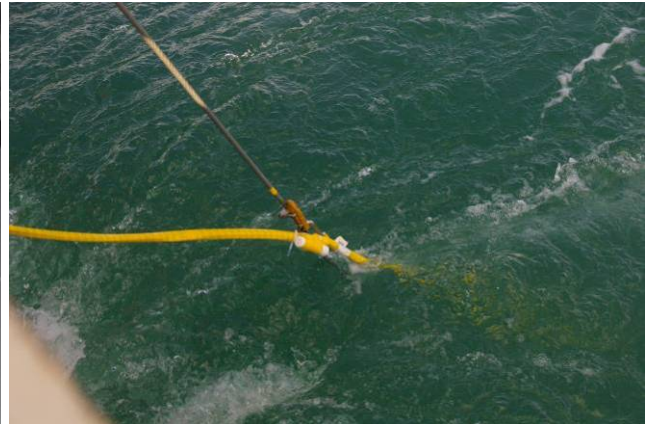
Figure 14 Ligne de prélèvement avec profondimètre
