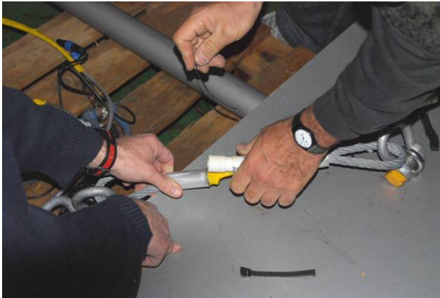
Figure 13 Mise en place d'un profondimètre
